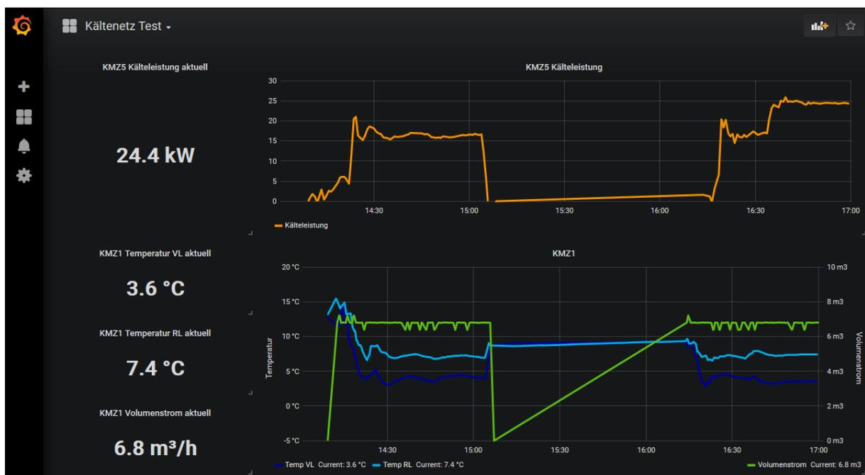
Abbildung 83 Visualisierung von Messdaten im Kältenetz mittels Grafana
