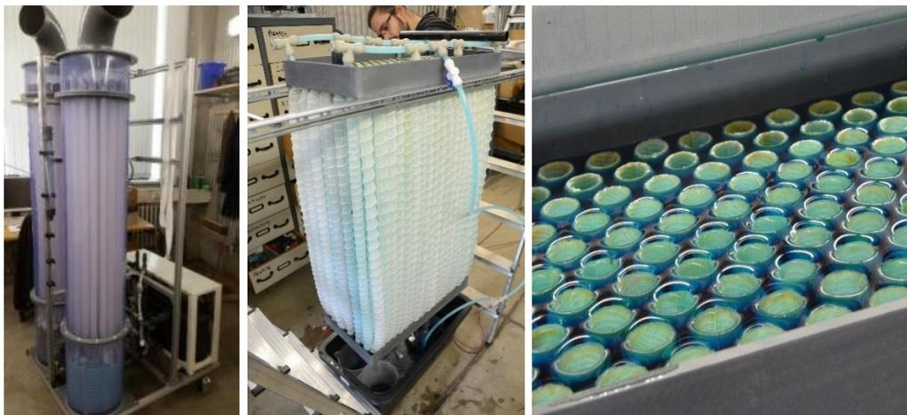
**Abbildung 54** *Neu entwickelter Absorber, Optimierung der Austauschfläche pro Absorbervolumen, Überlaufrohre mit optimierter und verstetigter Soleverteilung*
