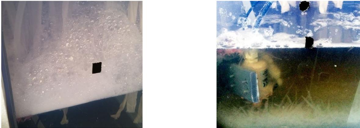
**Abbildung 57** *Verstärkte Schaumbildung beim Ab- bzw. Desorptionsprozess (links), Kristallisation der Sole nach Abkühlung stark konzentrierter Sole (rechts)*
