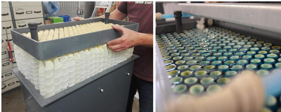
**Abbildung 63** Regeneratorkolonnen im Solenetzwerk, Verteileinheit mit Test zur gleichmäßigen Beschickung von Sole auch bei sehr kleinen Volumenströmen
